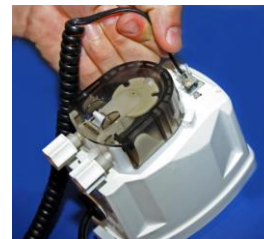
Figura 3. Instalação do Programador
